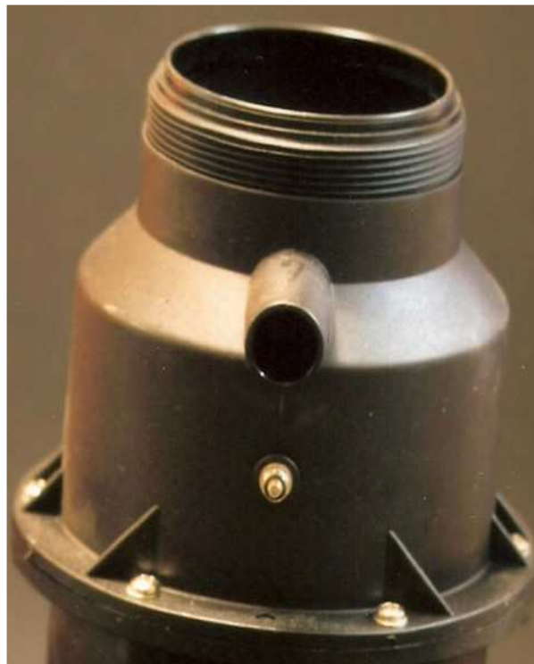
Campana di dissipazione visione esterna fissata al corpo motore da 8 viti.
