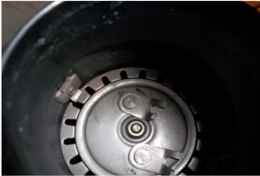
INTERNO CAMPANA DI DISSIPAZIONE TRACIANTE- ALETTE- ANELLO DENTATO- PIATTO ROTORE-.
