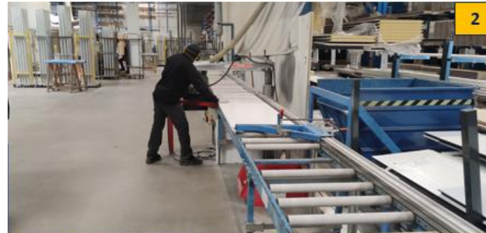
Cut to size if you have not invested in a big traditional CN (see step 3) Coupe à mesure si vous n'avez pas investi dans un grand centre d'usinage (voir étape 3)
