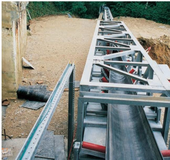
*Pipex e Piflex sono nastri trasportatori progettati per i sistemi di trasporto a nastro tubolare, caratterizzati rispettivamente da una carcassa resistente di tessuto sintetico multitelo o di cavi d'acciaio.*
