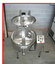
**Sistema di reclinazione manuale della vasca** che facilita le operazioni di scarico totale del prodotto e quelle di lavaggio della macchina
