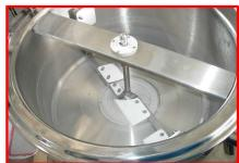
**Pala raschiante fondo e fascia** completamente amovibile con motore a giri variabili costruita in acciaio inox con palette raschianti in TEFLON alimentare.
