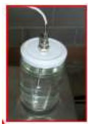
**Sonda all'interno del barattolo** per controllare, in fase di pastorizzazione a 100°C il raggiungimento della temperatura al cuore del prodotto.
