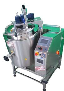
I cuocimix elettrici da 30/50/100 lt sono disponibili anche nella **versione in vuoto** poiché dotati di un sistema di pompa vuoto che consente di creare una depressione all'interno della macchina, di lavorare a basse temperature.
