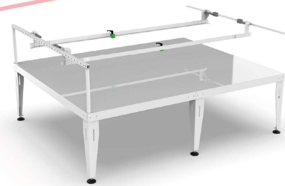
Tavolo di raccolta con bracci pneumatici Delivery table with pneumatic shafts for product collection
