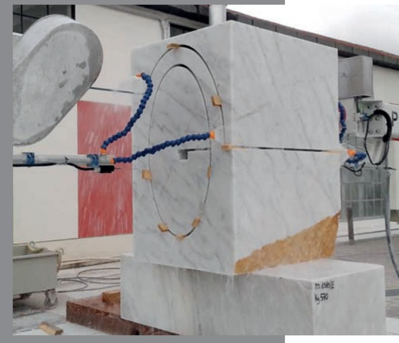
La machine à fil diamanté de la série CONTOUR PLUS peut réaliser n'importe quel façonnage en contrôlant les axes à disposition (de 2 jusqu'à 8), c'est-à-dire travaux d'art funéraire, formes cylindriques et coniques en général. Grâce à la vitesse de coulissemement du fil diamanté variable au moyen de l'inverseur de fréquence, on peut couper marbre, granit et pierre, simplement en changeant la vitesse par rapport à la dureté du matériel à couper, à la taille du bloc et au fil diamanté utilisé.
