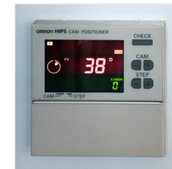
9. Electronic cams (OMRON) / Elektronisches Nockenschaltwerk (OMRON) / Elektronisch nokkenschakelwerk (OMRON)
