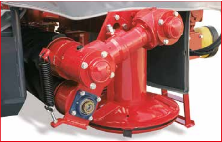
Doppia trasmissione del condizionatore scatola a bagno d'olio - Double transmission de conditionneuse à bain-d'huile
