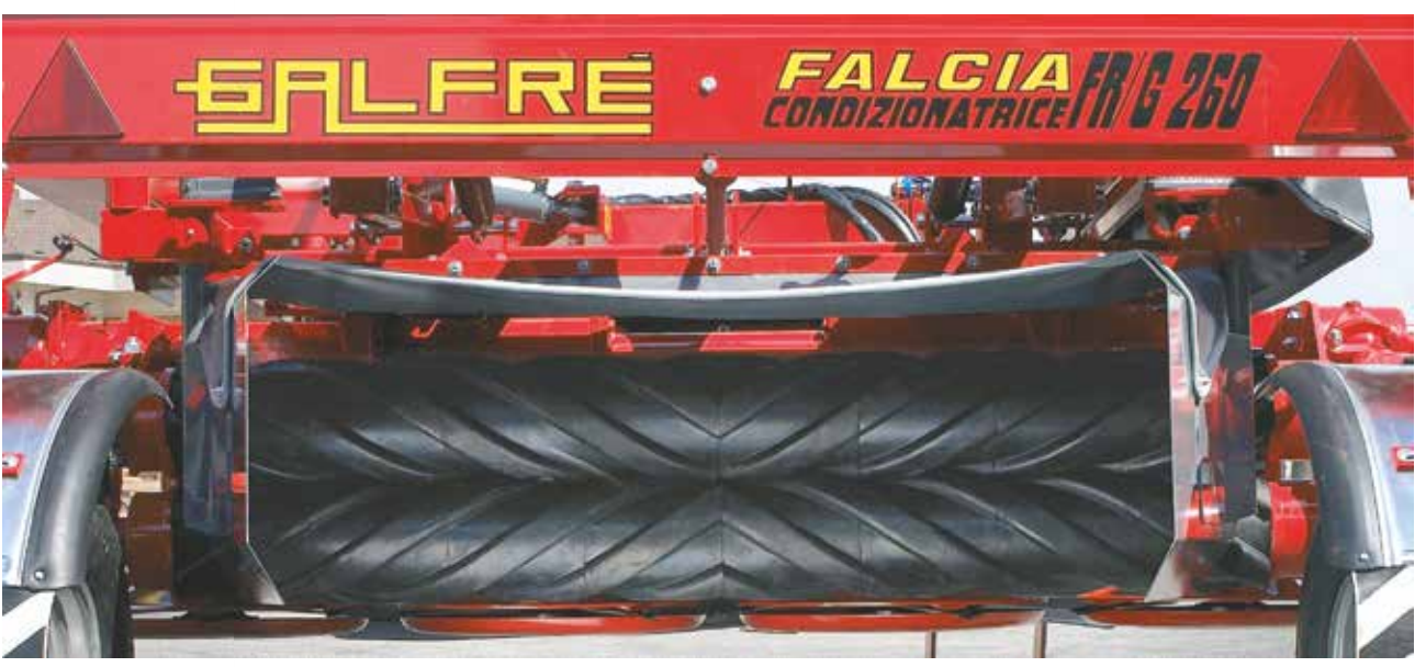
Condizionatore a rulli in gomma elicoidali Conditionneuse à rouleaux hélicoïdaux en caoutchouc
