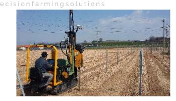
RTK SYSTEMS FOR DRILL - POLE PLANTING SYSTEM - VINE POLE PLANTING SYSTEM
