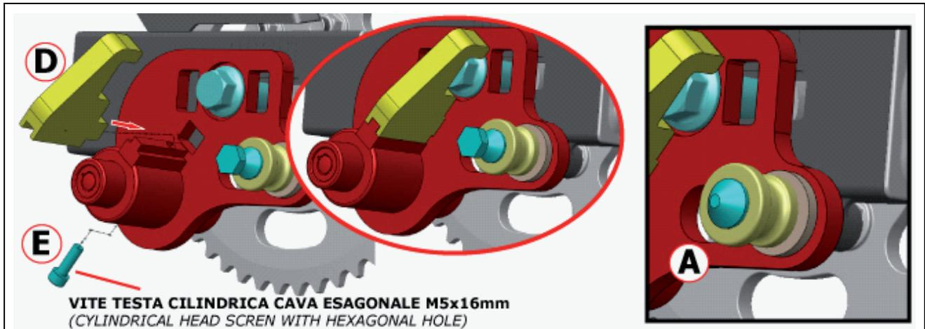
**1)** Montare il componente **(D)** come da foto e bloccarlo con la vite **(E)**
