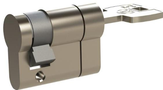
**Provvisto di sistema SAFE-BREAK:** In caso di effrazione il cilindro non permette di arrivare al funzionamento della serratura, rompendosi nella zona appositamente indebolita. Senza questo sistema, il cilindro si romperebbe nella zona centrale, dove è fissata la vite, potendo così essere sfilato dalla serratura.
