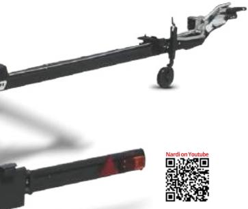
ALLOWS HEADER LOADING/UNLOADING AT GROUND HEIGHT. THE HYDRAULIC SUPPORT RISES ABOVE THE AXLE FOR ROAD TRANSPORT.
