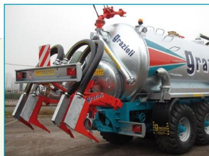
Interratore con sollevatore idraulico.
