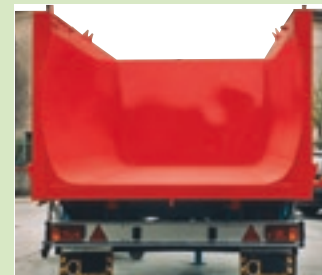
Cassone arrotondato e conico (DOMEX). Conic and round shaped dump (DOMEX).
