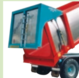
Portellone a tenuta. Perfectly watertight door.
