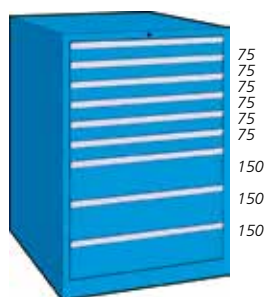
● h. 1000 mm • 9 cassetti M100 95 estrazione parziale M100 95T estrazione totale 200 kg M100 95V estrazione totale 75 kg
