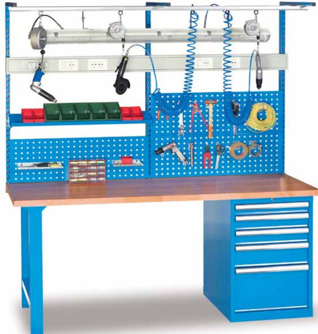
Per utilizzare nella maniera migliore il banco da lavoro, lo abbiamo dotato di una struttura posteriore o parete attrezzata, accessoriabile con una vasta gamma di articoli, per far sì che tutto sia a portata di mano dell'operatore.
