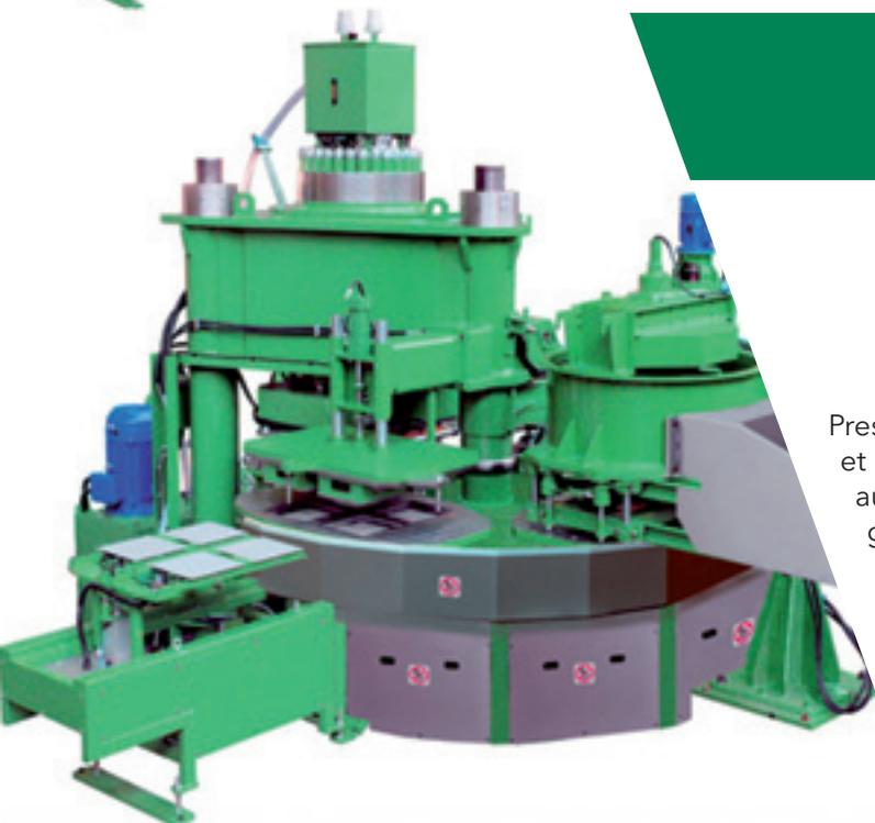
Presses automatiques rotatives pour la production de carreaux monocouche et bicouche. Lignes complètes pour la production et finissage: automatisation, calibreuses, gréseuses, polisseuses, palettiseurs, grenailleuses, four de séchage et machines accessoires. Lignes de cirage, brossage. Décoration digitale sur carreaux et dalles en ciment aggloméré.
