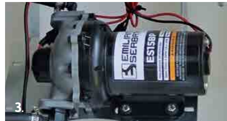
1. Pompa da 3,8 l/min per mod. 30. 3.8 l/min pump fitted on mod. 30.
