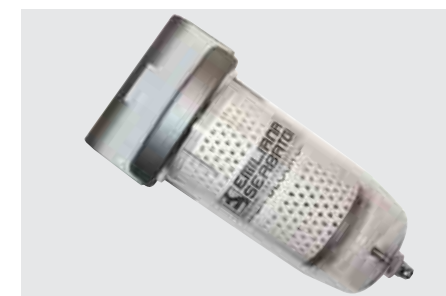
ES-Filter: 70 l/min. Capacité de filtrage: 10µm d'absorption d'eau et 5µm d'impuretés. EES-Filter: 70 l/min. Filterkapazität: 10 µm bei Wasser, 5 µm bei Verunreinigungen.
