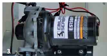
1. Bomba de 3.8 l/min para modelo 30. Bomba de 3.8 l/min para modelo 30.
