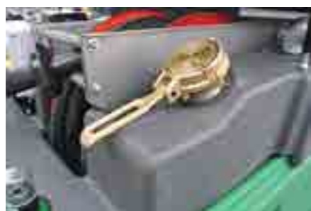
Заливная горловина 2". Filling quick cap 2".
