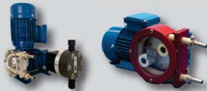
Produzione di pompe per processi industriali con teste di pompaggio in alluminio o plastica rigida. Portata da 6 a 1500 litri/ora. Pressione standard 2 Bar. Perfettamente autoadescanti. Flusso reversibile. Motori IP55 - 4 poli a 230/400 Volt trifase. Possibilità di accoppiamento con pompa dosatrice elettromeccanica a membrana/pistone.
