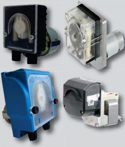
Produzione di pompe per macchinari e sistemi O.E.M. a portata fissa e con motore a vista. Portata da 0,05 litri/ora a 200 litri/ora. Pressione standard 1 Bar. Autoadescanti. Flusso reversibile o monodirezionale. Motori standard a 24V e 230V.
