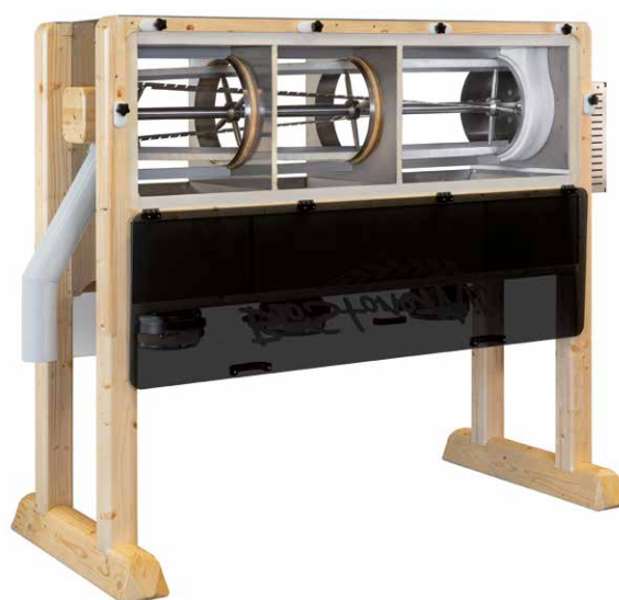
Macchina aperta con stacci smontati e vista del rotore
