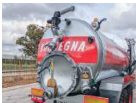
Ferrigatore montato posteriore Back fertilising-irrigation jet
