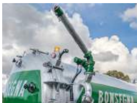
Ferrigatore montato al lato Lateral fertilising-irrigation jet
