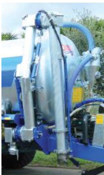
Braccio con prolunga in acciaio inox Stainless steel suction pipe extension
