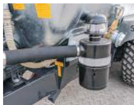
Silenziatore per decompressore Anti-noise reducing filter
