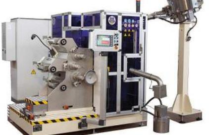
Macchina automatica per la decorazione offset-secco fino a 4 colori + lacca. Completa di torretta intermittente a 16 stazioni.
