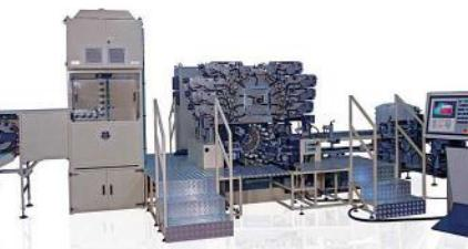
Macchina automatica per la decorazione offset-secco fino a 8 colori con esiccazione della lacca fuori mandrino, in forno UV separato. Completa di torretta intermittente verticale a 18 posizioni.
