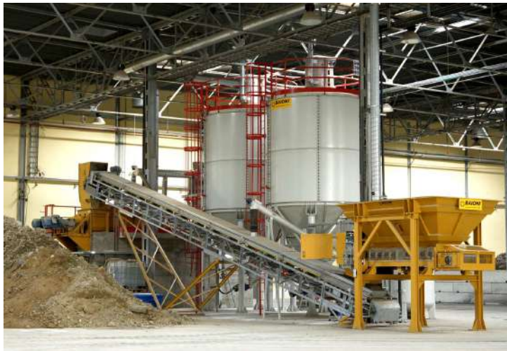
Impianti di Stabilizzazione/solidificazione fanghi Solidification/Stabilization treatment plants for waste Traitement de stabilisation/solidification des déchets Tratamiento de estabilización/solidificación de residuos
