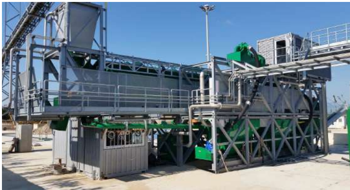
Impianti mobili di bonifica fanghi e terreni contaminati Mobile soil remediation plants Installations mobiles pour le traitement de boues et des sols contaminés Plantas móviles para el tratamiento de suelos y lodos contaminados
