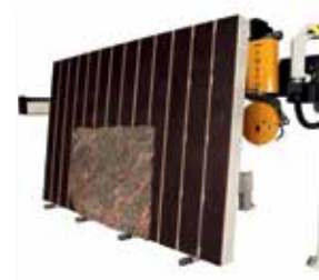
HYDRAULIC TILTING WORKTABLE ▶ inclinazione oleodinamica del banco
