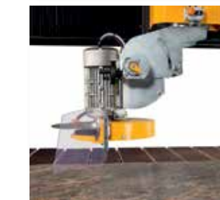
HEAD TILT FROM 90° TO 0° ▶ inclinazione della testa da 90° a 0°
