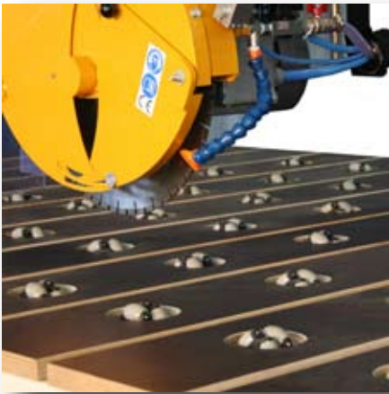
HYDRAULIC MOTORIZED POP-UP ROLLERS ▶ Rulliera oleodinamica motorizzata
