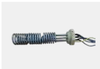
Resistenza elettrica unità interna da kW 3/6/9 trifase per integrazione impianto e ACS completa di termostato di regolazione e di sicurezza gestita da controllore.
