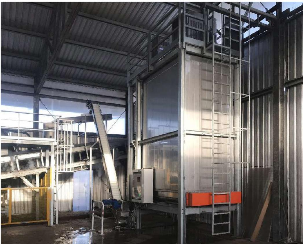
Latina, Italia. Silos di stoccaggio ghiaccio con sistema di estrazione multicoclee e dosatore volumetrico. Struttura autoportante per posizionamento macchine.
