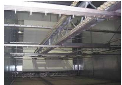
Deposito di stoccaggio per grandi quantità di ghiaccio con erosione superiore e sistema LIFO
