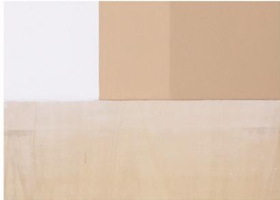
**Applicazione** su legno. Solo stucco (bianco), con una mano di pittura (parte centrale) e con doppia passata di pittura (parte dx)
