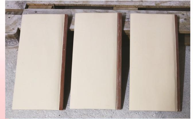
**Tavellina** con Intostukcem: tavellina con Intostukcem con una mano di pittura a sx, tavellina con Intostukcem con 2 mani di pittura al centro, tavellina con Intostukcem con 3 mani di pittura a dx.
