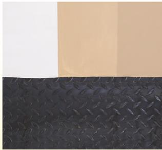
**Applicazione** su ferro non liscio. Solo stucco (bianco), con una mano di pittura (parte centrale) e con doppia passata di pittura (parte dx)
