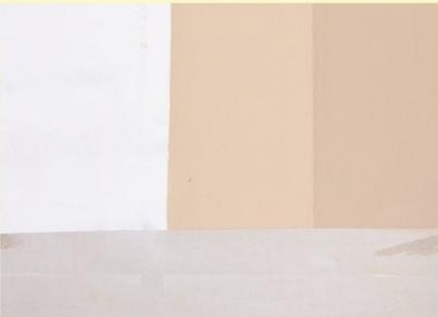
**Applicazione** su ferro liscio. Solo stucco (bianco), con una mano di pittura (parte centrale) e con doppia passata di pittura (parte dx)
