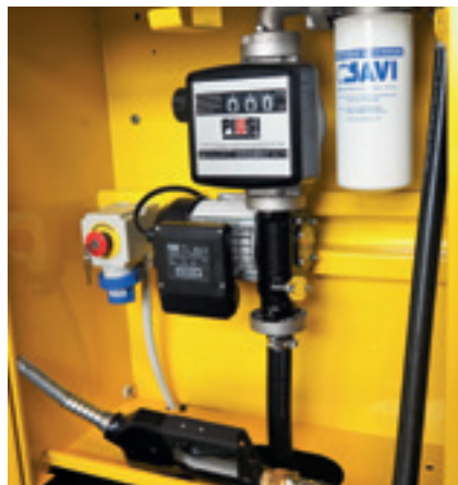
Armadio Box 70 water captor Pompa portata nominale 70 L/min
