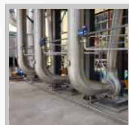
TFM costruisce linee per la concentrazione di succhi di frutta o pomodoro: possono essere impianti da piccole capacità da 500 l/h sino a 50.000 l/h di acqua evaporata con diversi livelli di automazione dalle più semplici alle più complesse.
