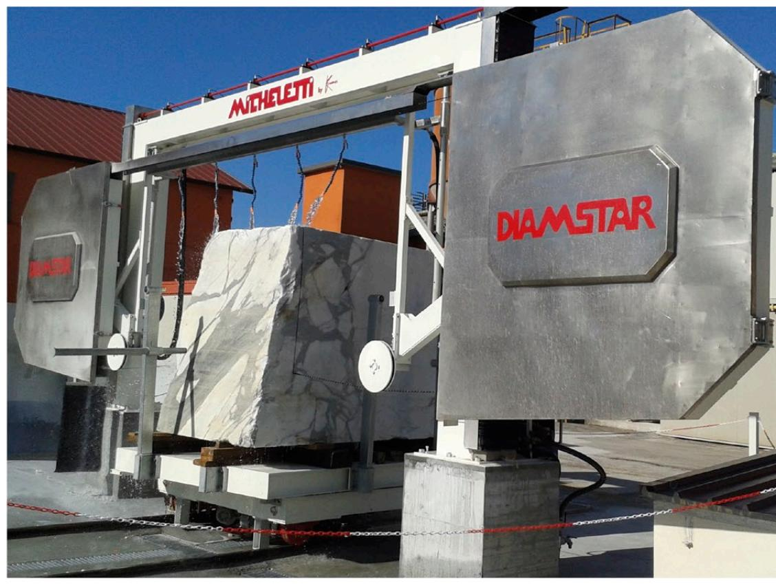
L'impianto a filo diamantato DIAMSTAR TECH, nelle sue 3 versioni, stazionario, mobile su rotaie e doppio (fisso + mobile), è stato progettato per la riquadratura e per il taglio di spessori nel marmo e nelle pietre in generale e, nel modello a velocità periferica variabile, anche nel granito.
