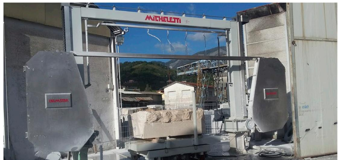
La machine à fil diamanté DIAMSTAR TECH, produit en 3 versions, stationnaire, mobile sur rails et double (stationnaire + mobile), a été conçue pour l'équarrissage des blocs et la coupe de plaques et épaisseurs en marbre et pierre et aussi en granite, grâce à la vitesse linéaire du fil diamanté variable au moyen d'un inverseur de fréquence.
