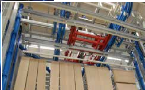
Der Power-and-Free-Förderer zeichnet sich durch hohe Einsatzflexibilität und modulare Anpassung an die Einsatzanforderungen in komplexen Produktionsabläufen aus.
