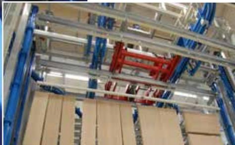
*El transportador birrail puede ser de dos tipos, aéreos o de suelo. Modulable según las diferentes necesidades de un ciclo de producción complejo.*
