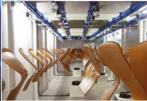
*En los transportadores monorail la función de la cadena biplanar es doble: tractora y portadora.*
