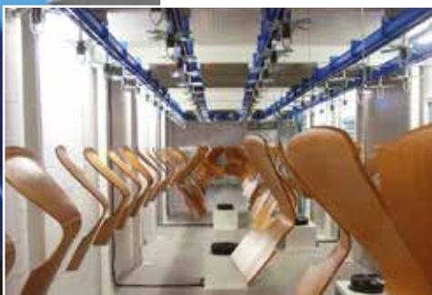
*У монорельсовых грузонесущих конвейеров бипланарная цепь несет двойную функцию: тяговую и несущую.*
