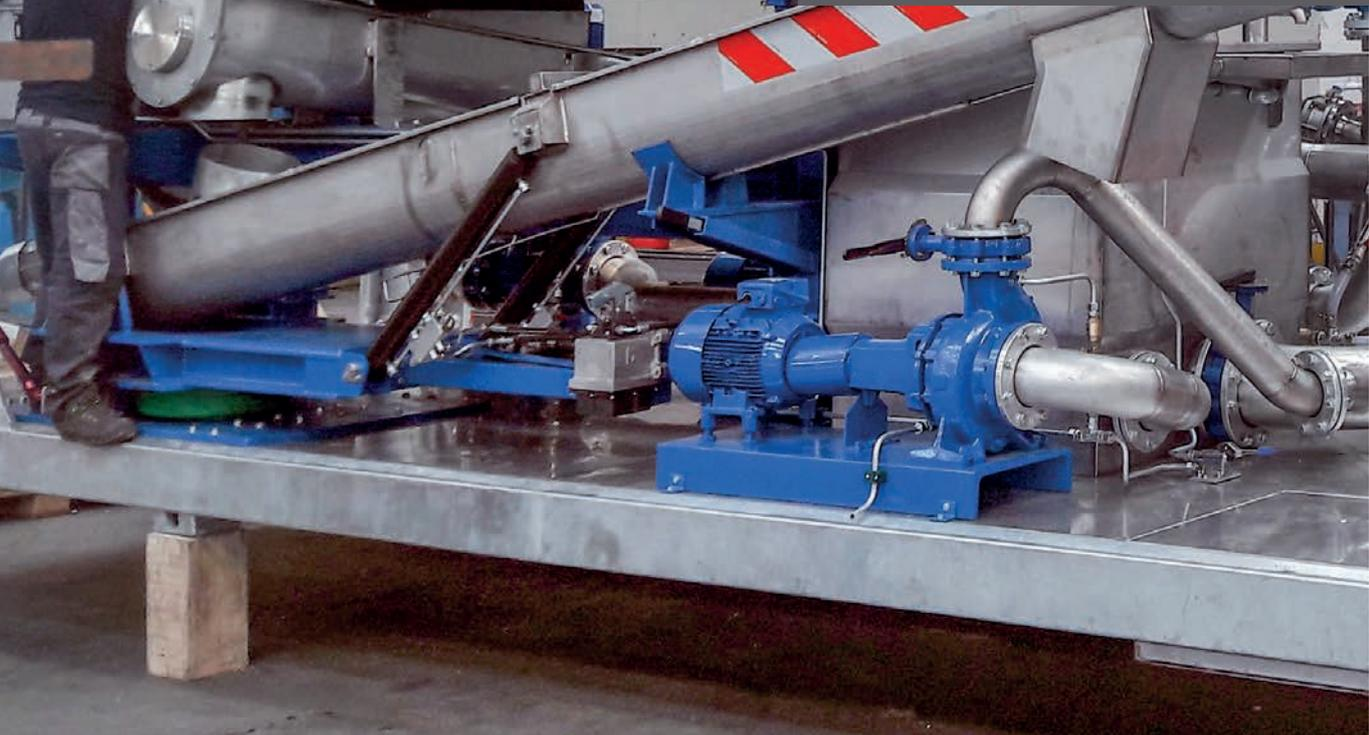
Olivero realizza impianti per il trattamento fanghi sia a terra, sia mobili installando tutta la componentistica su scarrabili o semirimorchi, in particolare coclee e impiantistica piping.
