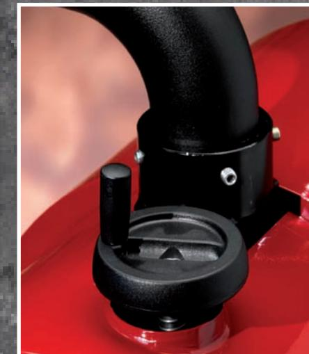
Dispositivo di espulsione manuale, in caso di anomalia macchina.
