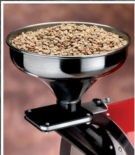
Sistema di caricamento per il caffè crudo, in acciaio inox bordato e senza spigoli direttamente collegato ad un dispositivo di apertura manuale a baionetta.
