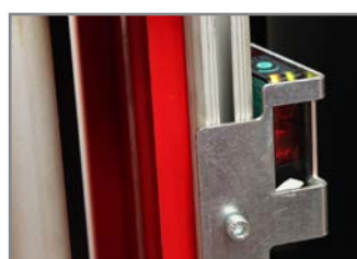
FOTOCELLULA LETTURA PALLET PHOTOCELL TO DETECT PALLET HEIGHT
