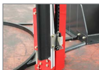
BUMPER DI ARRESTO MACCHINA SAFETY BUMPER
