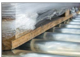
RULLIERA MOTORIZZATA TRASPORTO PALLET POWER ROLLER CONVEYOR
