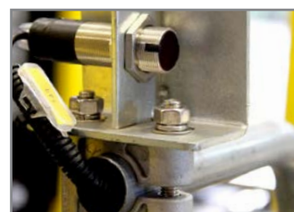
FOTOCELLULE RILEVAMENTO PALLET PALLET DETECTION PHOTOCELLS
