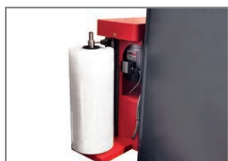
PRESTIRO FILM A DOPPIA MOTORIZZAZIONE DOUBLE MOTORIZED PRE-STRETCH FILM CARRIAGE
