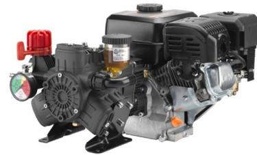
Groupe motopompe AR 303 BlueFlex™, Rato EHR 180, recul intégré, socle moteur seul. Pompe semi-hydraulique à trois membranes, pour une utilisation dans les secteurs du jardinage ou de l'agriculture semi-professionnelle. Parties en contact avec les liquides pompés en aluminium anodisé, et AISI 303/304
