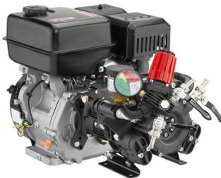
Groupe motopompe AR 503 BlueFlex™, Rato EHR 300, recul intégré, socle moteur seul. Pompe semi-hydraulique à trois membranes, pour une utilisation dans les secteurs du jardinage ou de l'agriculture semi-professionnelle. Parties en contact avec les liquides pompés en aluminium anodisé, et AISI 303/304
