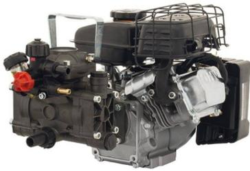
Groupe motopompe AR 202 BlueFlex™, Rato EHR 80-V, recul intégré, socle moteur uniquement. Pompe semi-hydraulique à deux membranes, pour une utilisation dans les secteurs du jardinage ou de l'agriculture semi-professionnelle. Pièces en contact avec les liquides pompés en aluminium anodisé, et AISI 303/304
