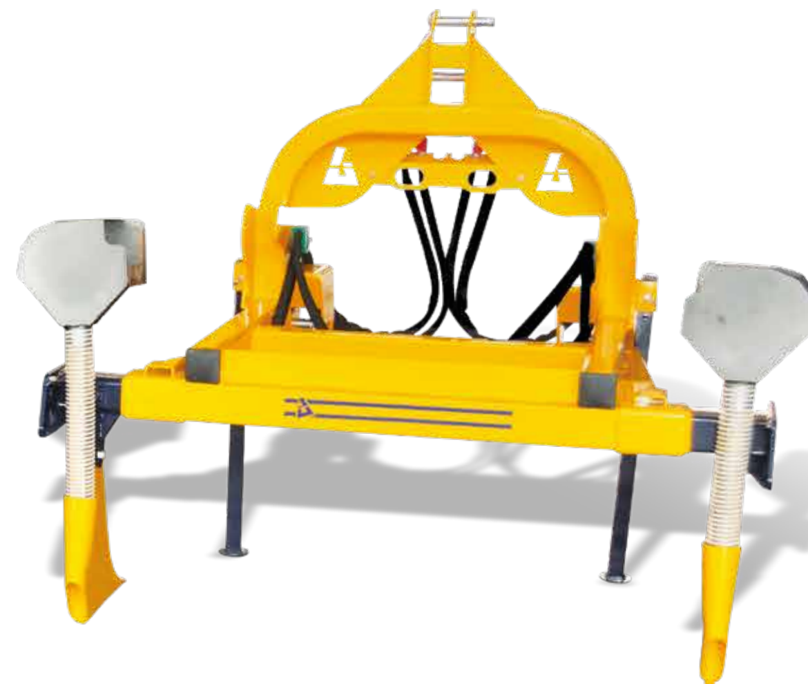
nelle varie versioni e regolazioni da localizzata / pieno campo ad INTERRATO. various versions and sets to spread under soil instead of localized and full-field. différentes versions et réglages pour passer à l'épandage sous-sol en lieu de localisé et plein champ.
