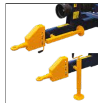
Piedino d'appoggio posizione lavoro e riposo Parking jack working and not working positions Béquille position travail et repos
