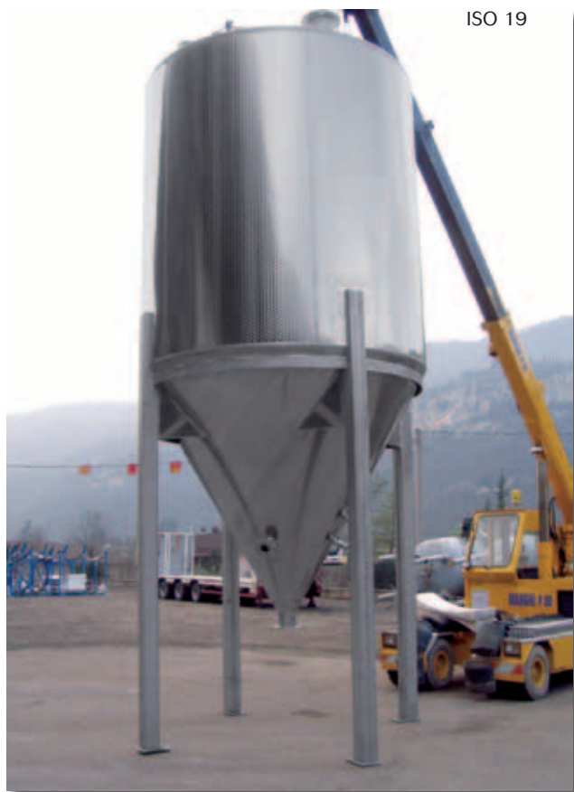
Serbatoio stoccaggio birra con cilindro isolato e schiumato e manto inox saldato
